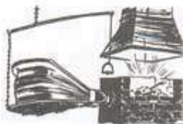
+ мехови су направе од коже које служе за издувавање ваздуха којим се распирује ватра, обично запаљен ђумур. У тој ватри загрева се гвожђе, а онда тако загрејано гвожђе постаје мекше, па га ковачи и поткивачи лакше кују.
